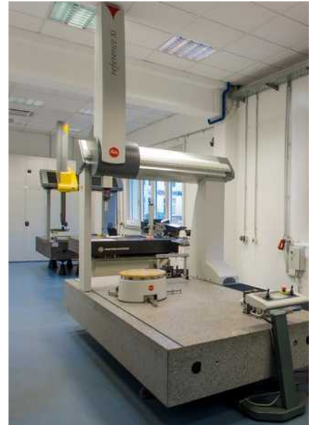
Typ: Referenz Xi 22 12 9 Max. Werkstückdimension: 2.200x1.200x900 mm Genauigkeit: 1,8µm + L/350µm
