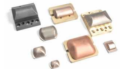
Verschiedene ECM Werkzeugelektroden
