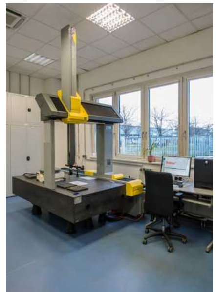
Typ: DEA Scirocco record 10-15-9 Max. Werkstückdimension: 1.000x1.500x900 mm Genauigkeit: 2,5µm + L/300µm
